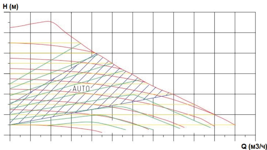
Кривая характеристик при работе в режиме постоянного давления.
