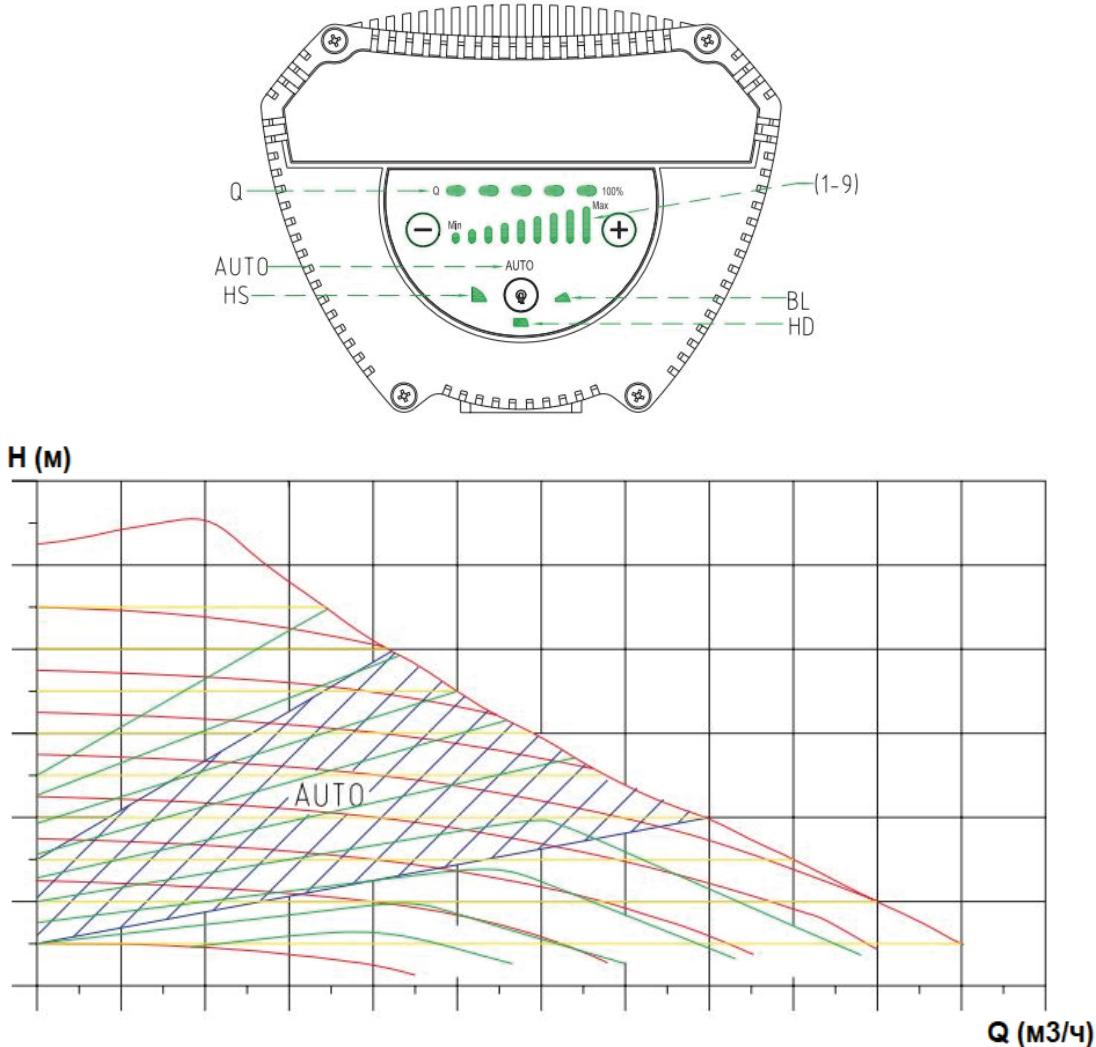
**Примечание:** кривая красного цвета обозначает работу при постоянной скорости (от 1 до 9), теневая область голубой кривой – автоматический режим, зеленая кривая – соотношение (от 1 до 9), желтая кривая – режим постоянного давления (от 1 до 9).
