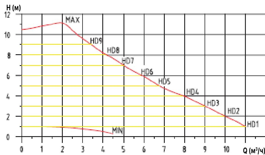
Кривая характеристик при работе в режиме постоянного давления.
