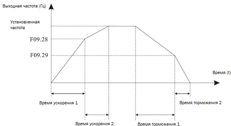
Рисунок 6-16 – Переключение между t ускорения 1 и 2 / торможения 1 и 2
