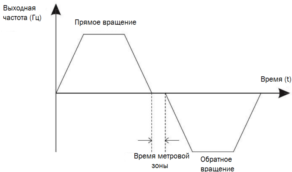
Рисунок 6-14 - Время мертвой зоны прямого/обратного вращения
