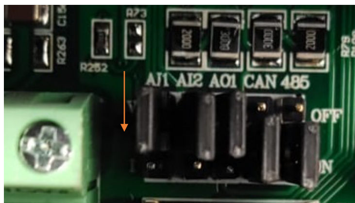
Рисунок 2. Установка перемычки входа AI1
